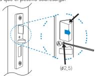
2. Cambie la dirección del pestillo y presiónelo hasta que se asegure dentro del mecanismo.
