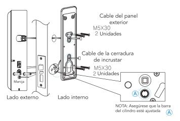
Conecte los dos cables a la unidad interior y fíjela con tornillos.
