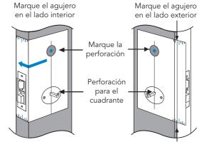
Perfore el agujero según se especifica (32mm) Ajuste la dirección de la manija en el panel exterior. Empuje hacia abajo la manija hasta una posición horizontal; un "Click" le confirmará que la manija se encuentra asegurada.
