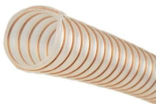
**Descripción:** Manguera tipo ducto en construcción extruída de Poliuretano transparente, reforzado con espiral de acero recubierto en bronce antiestático ideal para transporte neumático a granel. Resistente a productos químicos, abrasión y desgarró. Su construcción en PU con excelente flexibilidad y compresibilidad para fácil instalación y maniobrabilidad. Construída en materiales aprobados por FDA, exigidos en plantas farmacéuticas y de preparación de alimentos.
