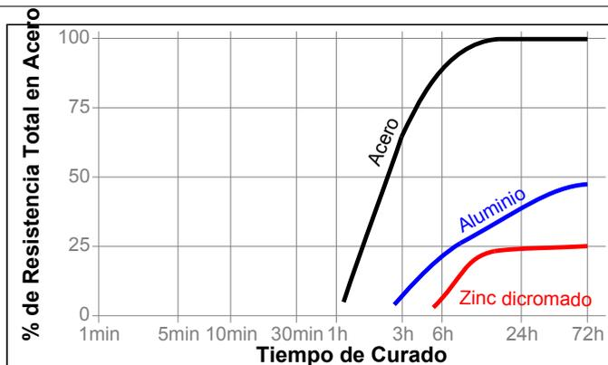
**Velocidad de Curado vs. Holgura de pegado** La velocidad de curado dependerá de la holgura de la unión. La gráfica siguiente muestra la resistencia al corte desarrollada con el tiempo en pernos y collarín de acero a diferentes holguras controladas y probadas de acuerdo a la norma ISO 10123.
